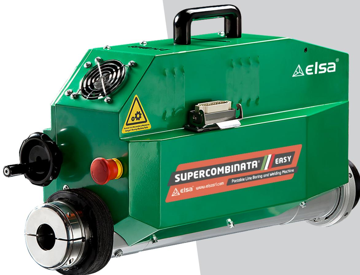
Станок **Supercombinata EASY**, имеющий стандартное оснащение, выполняет внутреннюю расточку и наплавку в диапазоне от  $\varnothing$  32 мм до  $\varnothing$  250 мм. С помощью комплекта дополнительных принадлежностей можно выполнять наружную расточку, шлифовку ортогональных поверхностей и выполнение гнезд под стопорные кольца С помощью принадлежностей можно предложить решения при наличии самых разнообразных требований при ремонте.
