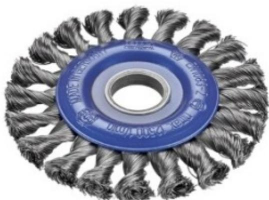
Щётка дисковая D 178 x 6 x 22,2 mm. OSBORN Жгутовая нержавеющая проволока. Щетки дисковые жгутовые на УШМ (Болгарка) для тяжелых зачистных работ по изделиям из нержавеющей, черной стали, выполняют агрессивную и эффективную зачистку благодаря витой скрученной в толстые жесткие жгуты нержавеющей проволоки. Корщетки предназначены в основном для обработки прямых лицевых сварных швов, снятие окалины, ржавчины и подобных работ.
